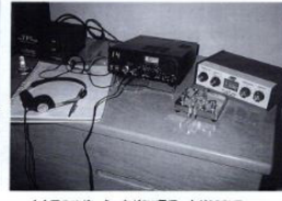
1 1台目のリグ一式。右がGW電源、中がSCOUT 555(35W OUT)、右がMFJのアンテナチューナー、3つで5.1kg。(写真4)
