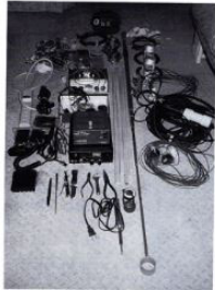
1 持ち参した機材、工具、アンテナ、ケーブル等の全てが、中央長いのがアンテナ支柱になる箱組式のゴルフボール型。 (写真1)
