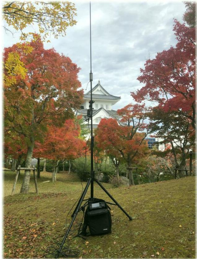
バーチカルアンテナの途中に取り付けたローディングコイルには使用するバンドに応じたタップが取り付けられています。運用バンドに応じたタップ位置が取扱説明書に記載されていますので、それを見ながらタップの
