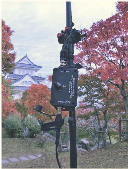
してノイズが最も大きいポイントに合わせます。そこでエレメントの長さやラジアルの長さを微調整すると運用周波数の近くに同調させることができます。なお、IC-705 には便利な SWR 測定機能があり、運用周波数における SWR を見ながらアンテナの整合を取ることができます。
