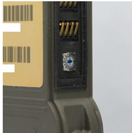
16 個の刻みがあるロータリースイッチを回してチャンネルグループを選択できる
