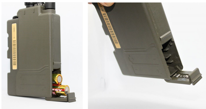
気密性の無い電池収納部。蓋は貧弱な造り。
