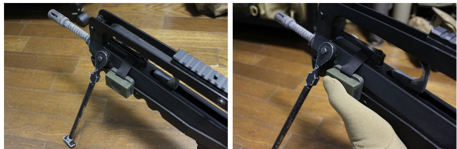
ワイヤレス PTT ボタンをライフルのハンドガードに取り付けたところ。銃を構えたまま送信できる。
