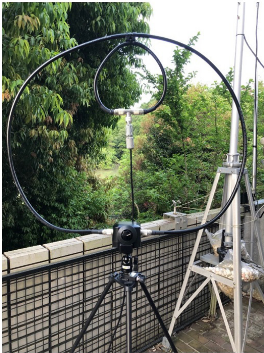
三脚に取り付けた HF マグネチックループアンテナ
