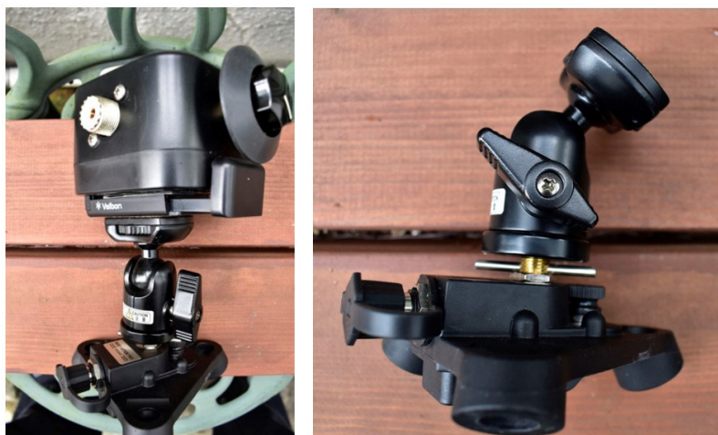
アンテナの基台部にカメラ用の雲台を取付けた様子
