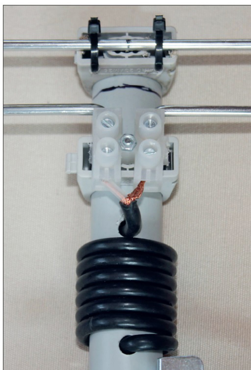
図 5 アンテナの給電部にクランプが取り付けられている様子 写真撮影: DK7ZB
