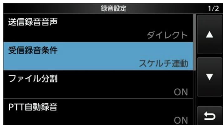
この状態で送信をすると設定した時間前(下の画像のように「録音設定」の「送信前録音」で設定します)から録音が始まります。
