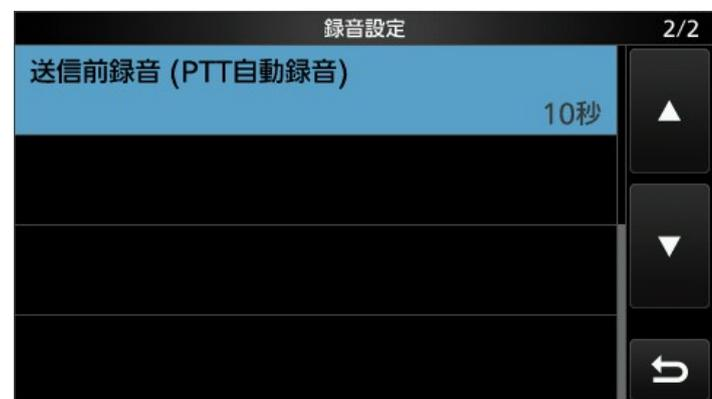
この送信前録音というのは録音状態にない状態でも PTT を押したり、CW で送信を開始すると、ここで設定した秒数をタイムマシンのようにさかのぼって、そこから録音が始まっていますので、自分がコールする前の相手局の CQ などから録音が残されます。これら録音機能は ICOM の固定局用リグである IC-7610 や IC-9700 などでも採用されている機能です。これを可搬型のリグにも採用していただいたことに感謝しています。
