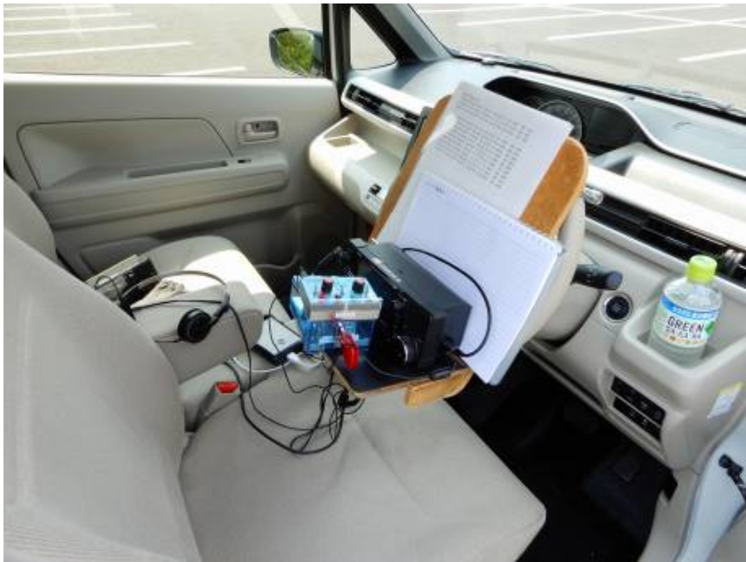
写真 1 鹿児島空港の近くの公園(霧島市)での運用の様子。 IC-705 のサーマルプロテクターが作動した場合には、2 台目の IC-705 と交換した。
