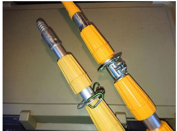
ストッパーを付けるか否かでステーを取る高さを変えられる
