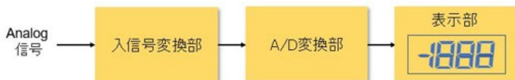
図1 デジタル計測器のブロック図
