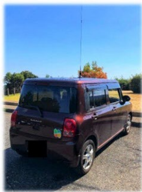
筆者のモービルシャック(スズキ ラパン) 2m のモービルホイップを取り付けたところ
