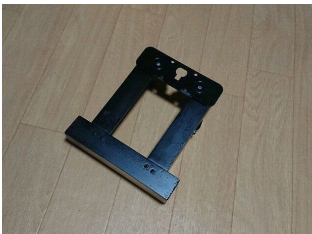
上部にはみ出す部分を切断してラッカースプレーで塗装
