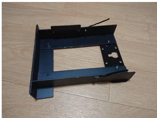
裏側: 外部 SP 用鉄板と固定に使う配線バンド
