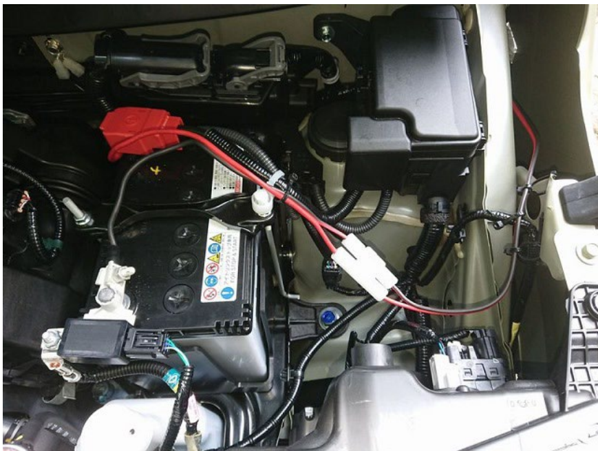
エンジンルーム助手席側外板との隙間に配線
