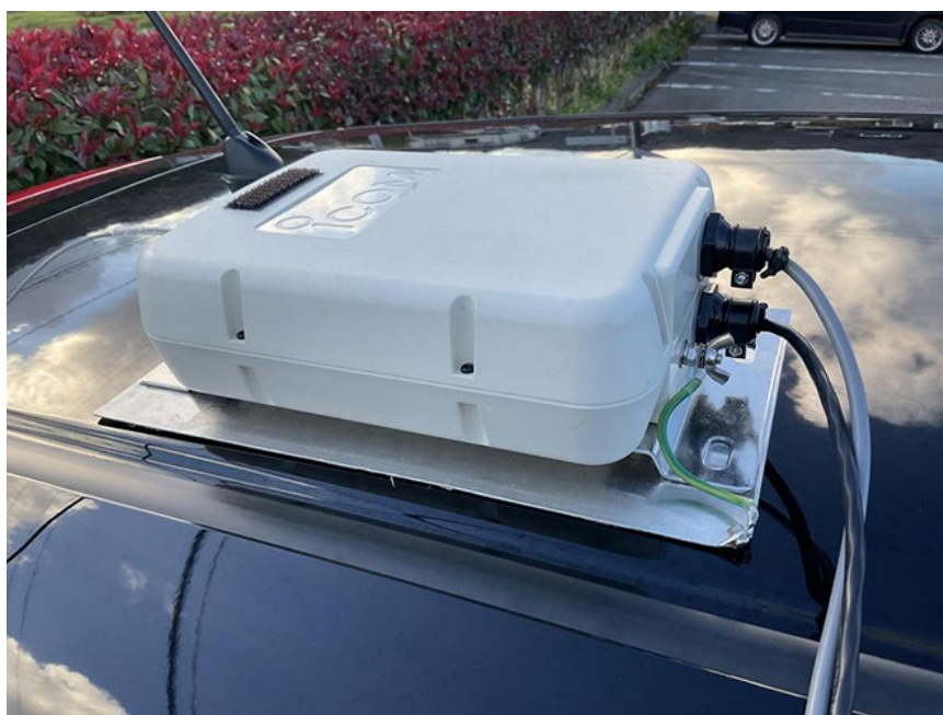
写真1 レンタカーに機材を設置した様子と、車の屋根に置いたアース板付きAH-4(オートアンテナチューナー)
